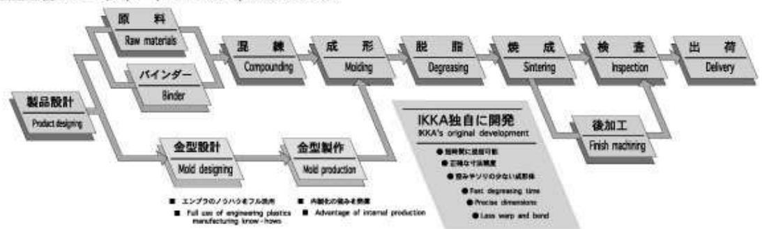
生産工程フローチャート Production process flow chart.
